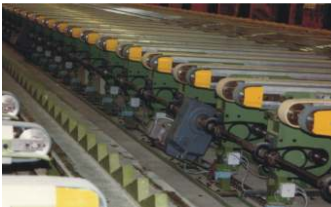
Querförderer für Aluminiumprofile „ Norsk Hydro “
